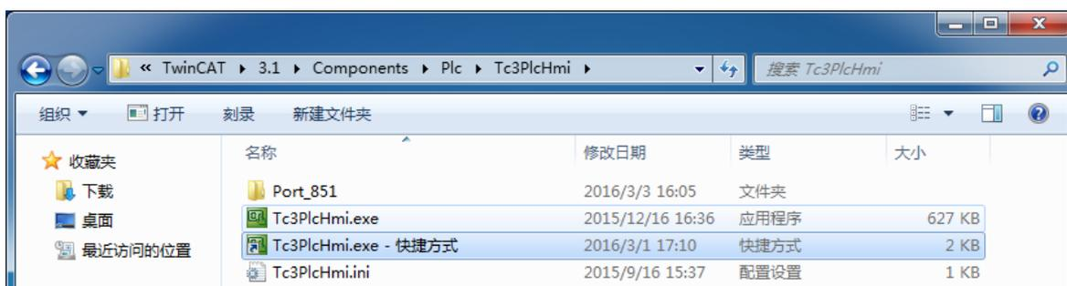
(2) 把这个快捷方式放到 C:\TwinCAT\3.1\Target\StartUp 这个文件夹里
