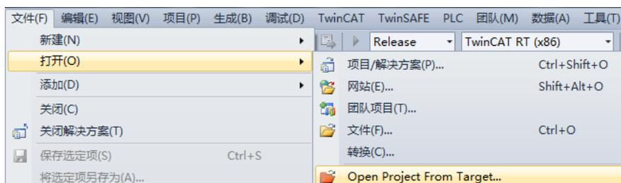
(7) 随后弹出选择框，选择你需要读取源代码的目标控制器。
