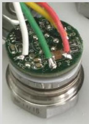
变送器(含电路板,V/mA 信号)
